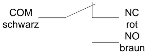
Endlagenschalter, sowohl für die „Geschlossen“ Signalisierung als auch für die „Offen“ und „Geschlossen“ Signalisierung können auch nachträglich aufgebaut, bzw. nachgerüstet werden.
