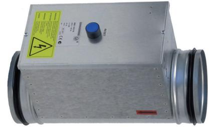
Die Heizregister müssen in einem Mindestabstand von 1 m nach dem Ventilator angeordnet werden. Die Luftgeschwindigkeit im Heizregister muss mindestens 1,5 m/s betragen
